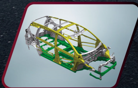
โครงสร้างตัวถัง (TECT) และระบบ NVH ถูกออกแบบจากเหล็กกล้าที่มีน้ำหนักเบาและทนทานต่อการ สึกหรอเป็นพิเศษ พร้อมทั้งช่วยลดเสียงรบกวนจากภายนอก และแรงสั่นสะเทือนขณะขับขี่ เพื่อความปลอดภัยสูงสุด และนุ่มนวลลดการเดินทาง
